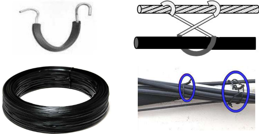
[그림 4-6] 강연선 케이블 고정(예시)
