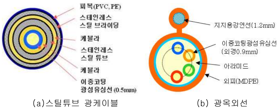
[그림 1-9] 스틸튜브 광케이블 및 광옥외선의 구조
